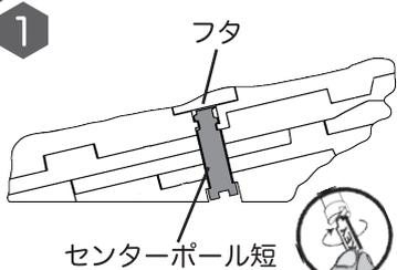
岩部分のセンターポール短は下から差し込み、組み立てキーを時計回りに回してネジで固定させてください。その後上からフタをはめてください。
