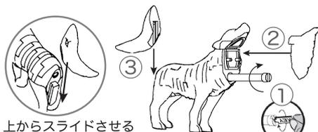
センターポールのネジ部分は強く締め過ぎないでください。材質上、破損する恐れがあります。
